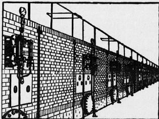
Einmauerung von 16 Zweiflammenrohrkesseln nach dem Bogensystem
