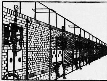
Einmauerung von 16 Zweiflammenrohrkesseln
