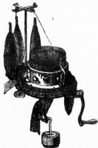
Die Bickford Strickmaschine ist einfach und dauerhaft in ihrer Construction, und leicht in Ordnung zu halten, sie strickt einen Strumpf, mit Baden und Beben complet in 5-10 Minuten, sowie 20,000 Stiche oder 22 Zoll Gewebe pr. Minute. Ein großer Vortheil der Bickford besteht darin, daß man auf einer Maschine mit verschiedenen Cylindern Alles, grob u. fein, Seide, Wolle, Baumwolle oder Garn stricken kann, ohne wie bei Anderen, separate Maschinen kaufen zu müssen.
