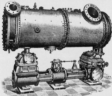
Combinirte Simplex Luft- und Kühlwasserpumpe mit Oberflächen-Condensator
